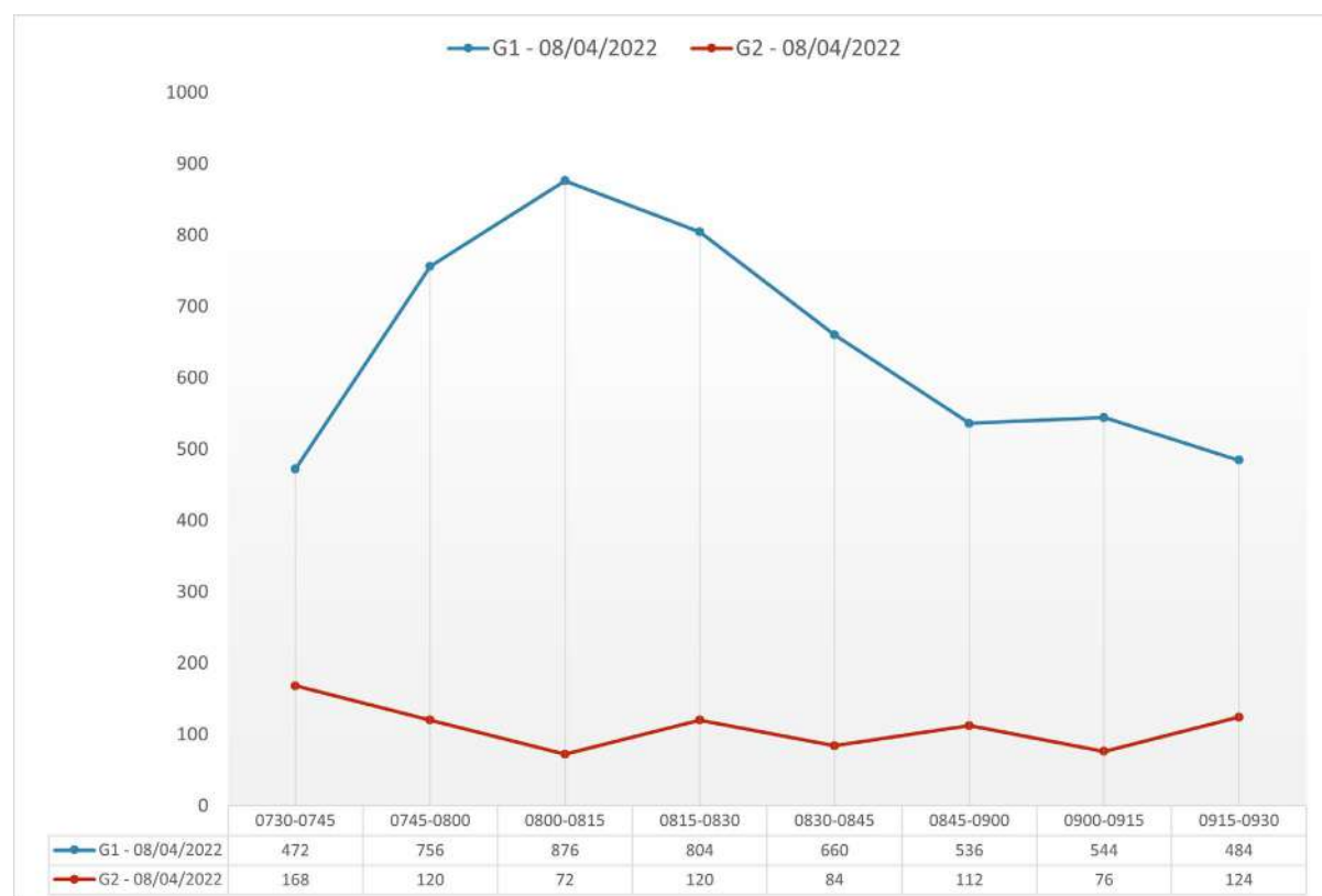
Figura 100 - Sezione G: Flussi orari (veicoli equivalenti) per le correnti di traffico G1 e G2
