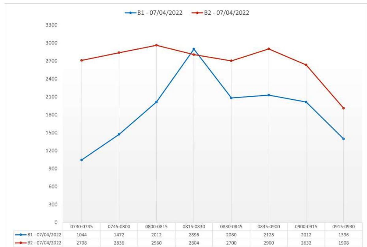
Figura 90 – Sezione B: Flussi orari (veicoli equivalenti) per le correnti di traffico B1 e B2
