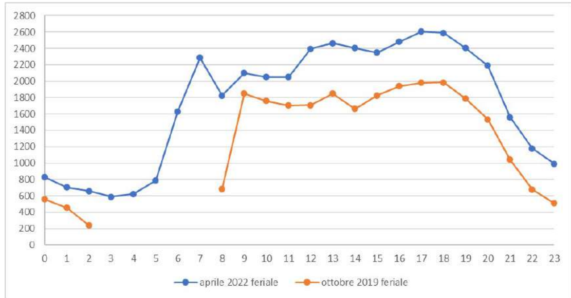
Figura 149 – Postazione MT6A Confronto dell'andamento orario medio dei flussi di traffico aprile 2022-ottobre 2019
